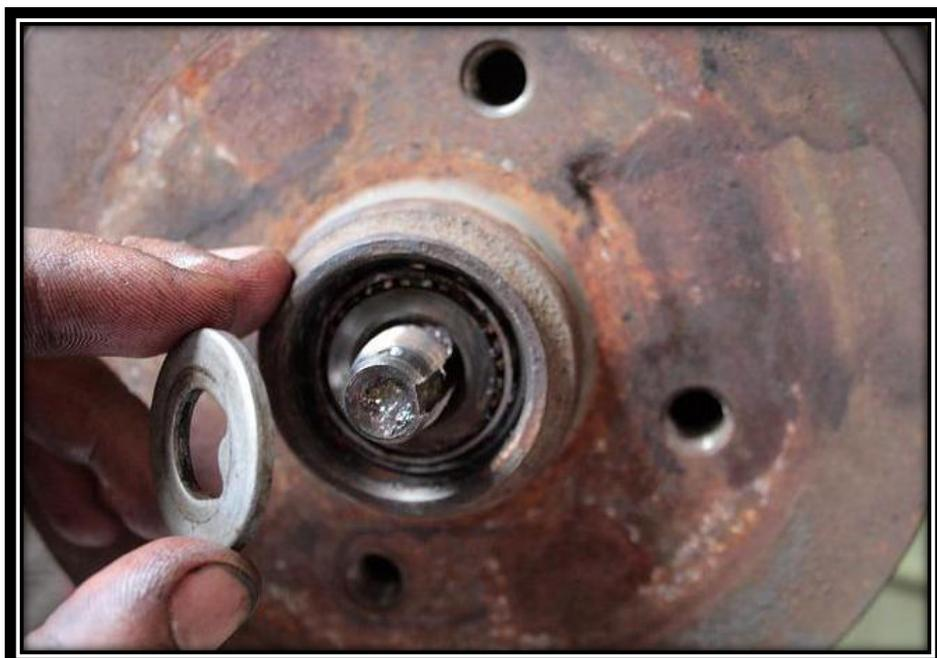
Après avoir bien positionné la rondelle sur son détrompeur, vissez l'écrou à la main puis au racagnac jusqu'à un serrage léger. Afin de compenser le jeu axial encore possible, tapotez sur son tour le tambour à l'aide du marteau et refaites un léger serrage à l'aide du racagnac/la clé coudée de 24.
