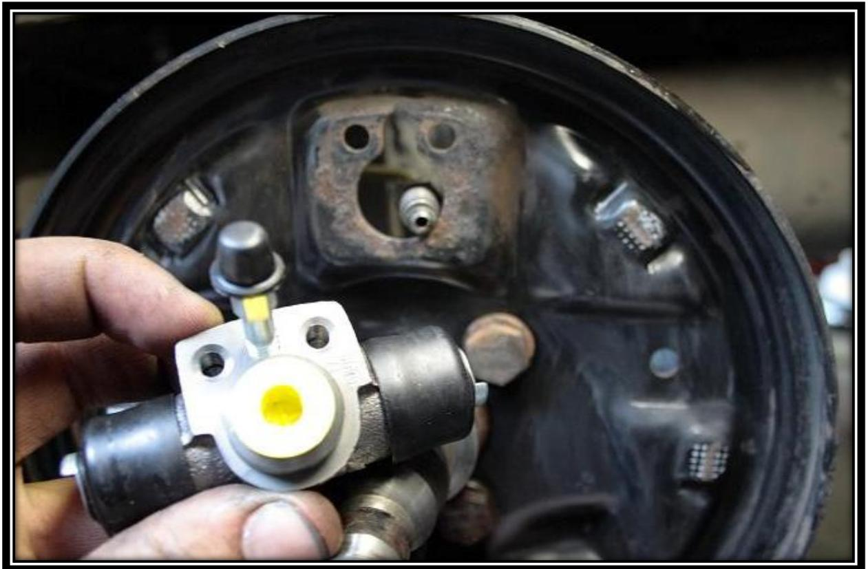
*Retirez bien l'opercule de protection des canaux du piston neuf ainsi que sa purge pour le passer dans son trou de fixation...*
