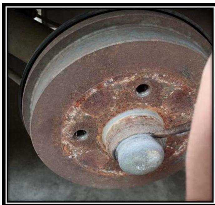
Une fois retiré, à l'aide d'un chiffon on retire un maximum de graisse pour avoir un accès propre à la goupille, le cale-écrou, l'écrou et sa rondelle.
