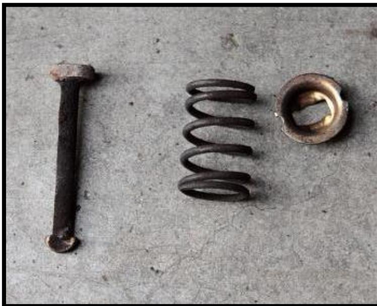
Nous voici arrivés au moment un peu délicat si on est seul sans avoir l'habitude (au démontage comme au montage). Retirer le câble de frein à main de son logement sur le bras de levier des garnitures... La solution la plus simple que j'aie trouvé au fil des freins arrière que j'ai fait sur mes Polo, c'est la pince coupante.
