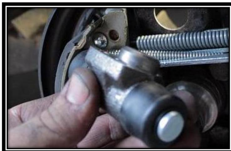
Faites entrer quelques tours de filet du rigide dans le piston et avant serrage définitif du rigide, n'oubliez pas de remonter les deux vis de fixation du piston que vous serrerez AVANT de serrer le rigide au piston. Pour le serrage du rigide, une fois de plus faites attention de bien positionner votre clé de 11 et de bien serrer le tout en ne mettant ni le rigide ni le piston en tension inutile.
