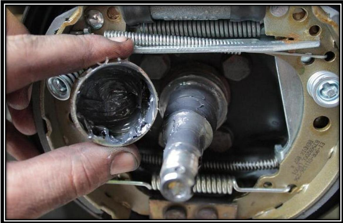
Sortez du pot de pétrole la rondelle, l'écrou, le cale écrou et prenez également le roulement extérieur. Séchez les pièces trempées dans le pétrole et veillez à ce que le roulement soit sain de toute crasse. Regardez que le roulement intérieur soit bien graissé, puis enfitez le roulement extérieur dans sa portée, et enfitez le tout sur la fusée avec la rondelle comme appui si vous le désirez.
