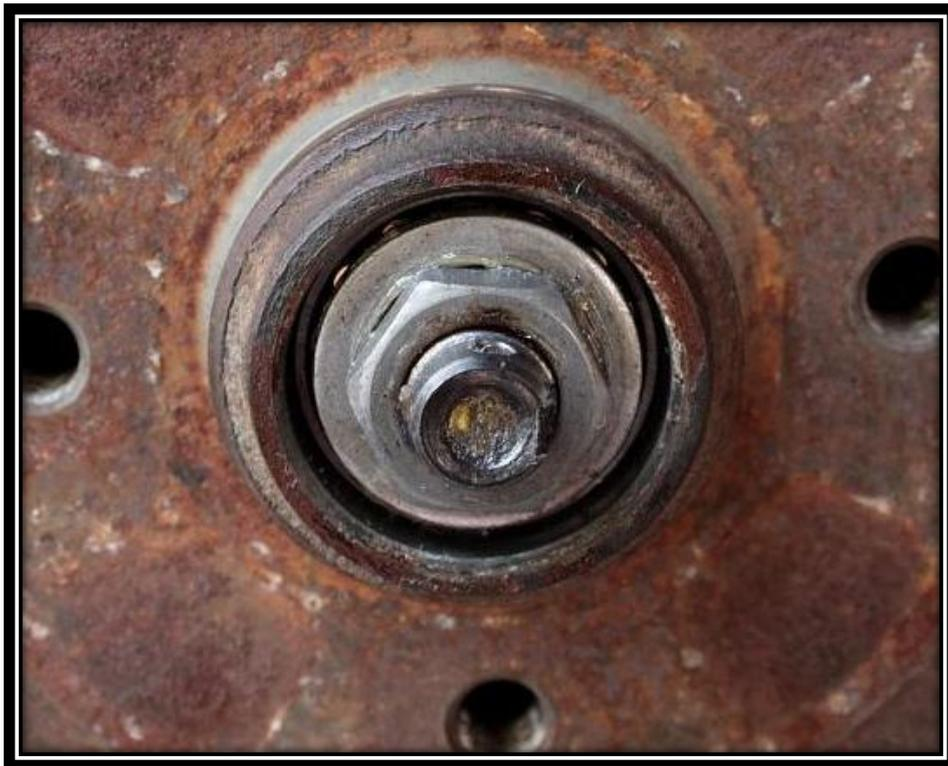
Retirer le tambour de son axe. Il faudra peut-être user d'un léger levier sur celui-ci, mais si ça ne vient pas ne forcez rien c'est inutile! Peut-être le frein à main relevé d'un cran ou encore tourner le tambour pour le débloquer de sa prise sur les garnitures.
